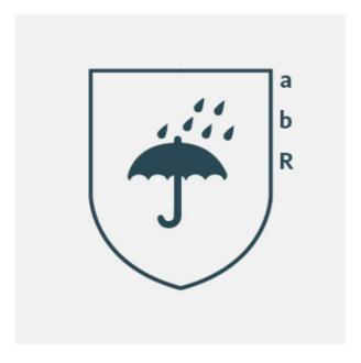
In dieser Norm werden die Eigenschaften der Materialien und Nähte von Schutzkleidung zum Schutz gegen Niederschlag, Schnee, Nebel und Feuchtigkeit klassifiziert, um einen angemessenen Wirkungsgrad sicherzustellen.
