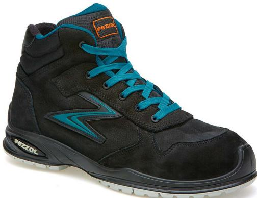
**Ausführung:** knöchelhoher Schuh**Zehenschutz:** Aluminiumkappe**Zwischensohle:** Textil durchtrittsicher**Zusatzanforderungen:** A , E , FO , P , SRC , WRU**Marke:** PEZZOL**Norm:** EN ISO 20345**Obermaterial:** Leder**Sohlenmaterial:** PU/PU**Verschlussystem:** Schnürsenkel
