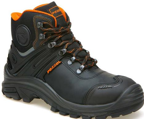
**Ausführung:** knöchelhoher Schuh**Zehenschutz:** Stahlkappe**Zwischensohle:** Textil durchtrittsicher**Eigenschaften:** Absatz , Spitzenschutz , Überkappe**Zusatzanforderungen:** A , E , FO , HI , HRO , P , SRC**Marke:** PEZZOL**Norm:** EN ISO 20345**Sohlenmaterial:** Gummi , PU**Verschlussystem:** Schnürsenkel
