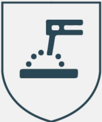
Die EN ISO 11611 legt Prüfverfahren und Leistungsanforderungen an Schutzbekleidung für Schweißen und verwandte Verfahren fest. Aufgabe der Schutzbekleidung ist es, den Träger vor kleinen geschmolzenen Metallspritzern, kurzzeitigem Kontakt mit Flammen sowie Strahlungswärme aus dem Lichtbogen zu schützen.
