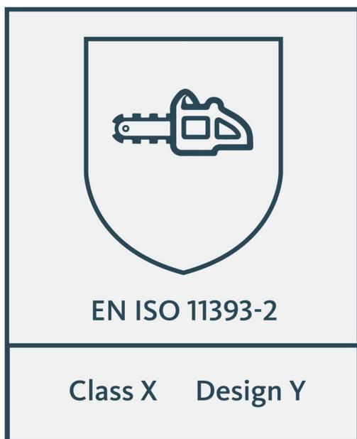
Bekleidungsstücke, die der Norm EN ISO 11393-2 entsprechen, bieten Schutz vor handgeführten Motor- und Kettensägen. Der geschützte Bereich sind die Beine. In die Kleidung ist eine Schicht aus sehr langen, feinen und reißfesten Fäden eingearbeitet, die bei Kontakt in das Antriebsritzel der Motorsäge gezogen werden und die Kettenbewegung innerhalb eines Sekundenbruchteils stoppen. Schnittschutzbekleidung ist unverzichtbar für jeden, der eine Kettensäge bedient.
