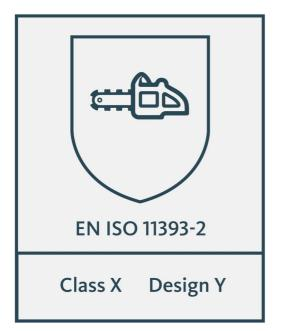
Bekleidungsteile, die der Norm EN ISO 11393-2 entsprechen, bieten Schutz vor handgeführten Motor- und Kettensägen. Der geschützte Bereich sind die Beine. In die Kleidung ist eine Schicht aus sehr langen, feinen und reißfesten Fäden eingearbeitet, die bei Kontakt in das Antriebsritzel der Motorsäge gezogen werden und die Kettenbewegung innerhalb eines Sekundenbruchteils stoppen. Schnittschutzbekleidung ist unverzichtbar für jeden, der eine Kettensäge bedient.
